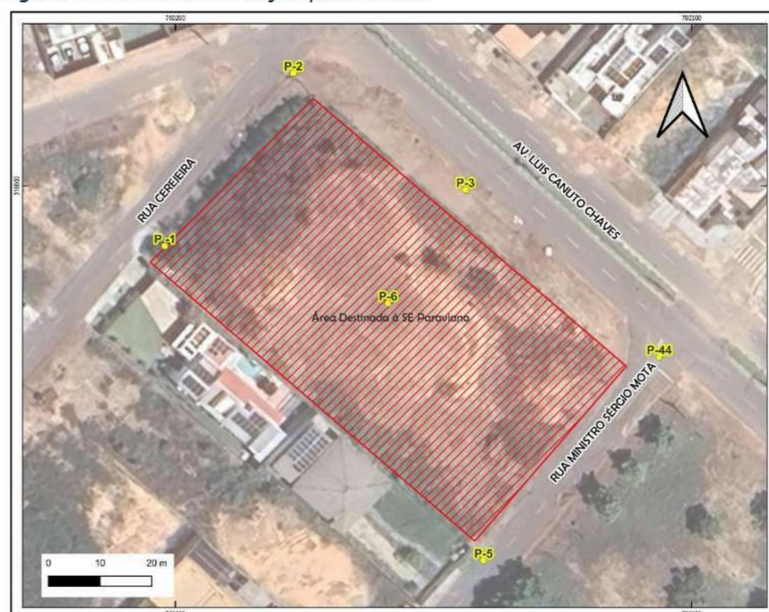
Figura 9 -Pontos de medição para ruídos
